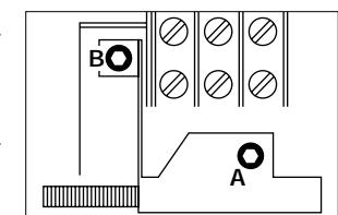
**16** Tourner la vis **A** à l'aide d'une clé mâle normale jusqu'à ce que l'interrupteur change de position lorsque la vanne est ouverte :
