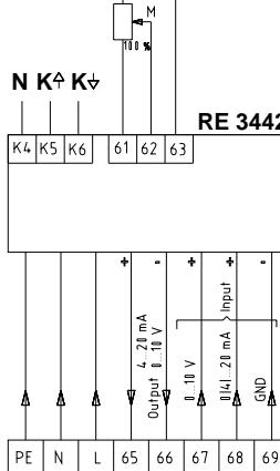
Zusätzliche Verdrahtung für Antriebe mit Thermoschalter:
