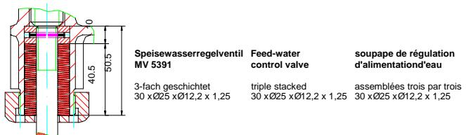
Bild 1 / figure 1: Schichtung der Federkopplung / arrangement of disc spring coupling / ressort accouplement
