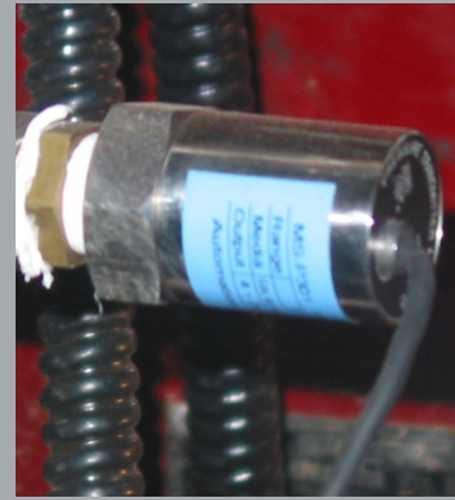
사진 19: 압력트랜스미터 4~20mA 압력 : PN 20 Bar
